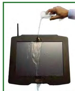
Test de resistencia al agua IP66
